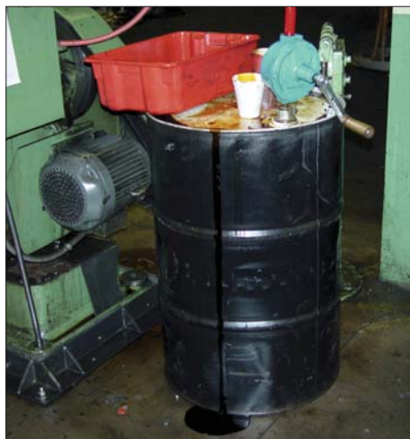
Oliespatten op de grond... een potentieel gevaar op slip- en valpartijen.
