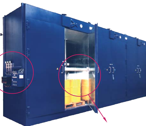
Warmtekamer - Ex (explosie veilig) - werkend op stoom voor 12 x 200 liter vaten op 3 paletten - alle onderdelen in RVS.
