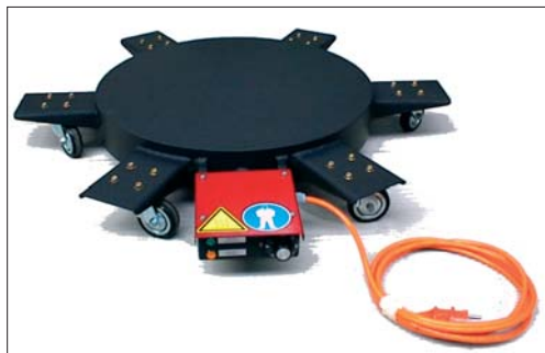
Electrische verwarmingsplaat (1,5kW) - diameter van 540mm . Met thermostaat 50-300°C. Leverbaar met verschillende opties.
